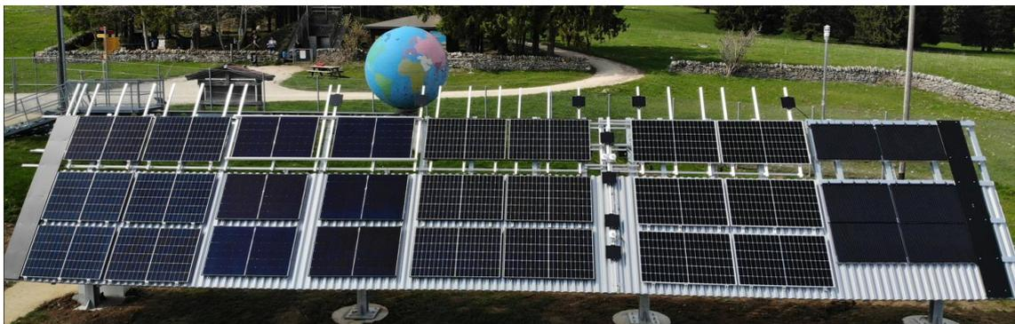
*(foto : installations de test du projet pilote 'PV Bench 23-24' à Mont-Soleil)*
